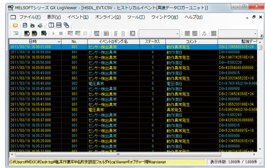
【イベントモニタ表示】 イベントロギング機能により収集されたイベントデータが、一覧形式で表示されます。
